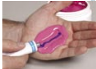
Etapa 3. Esprema uma linha de catalisador no comprimento da endentação e misture completamente à mão.
